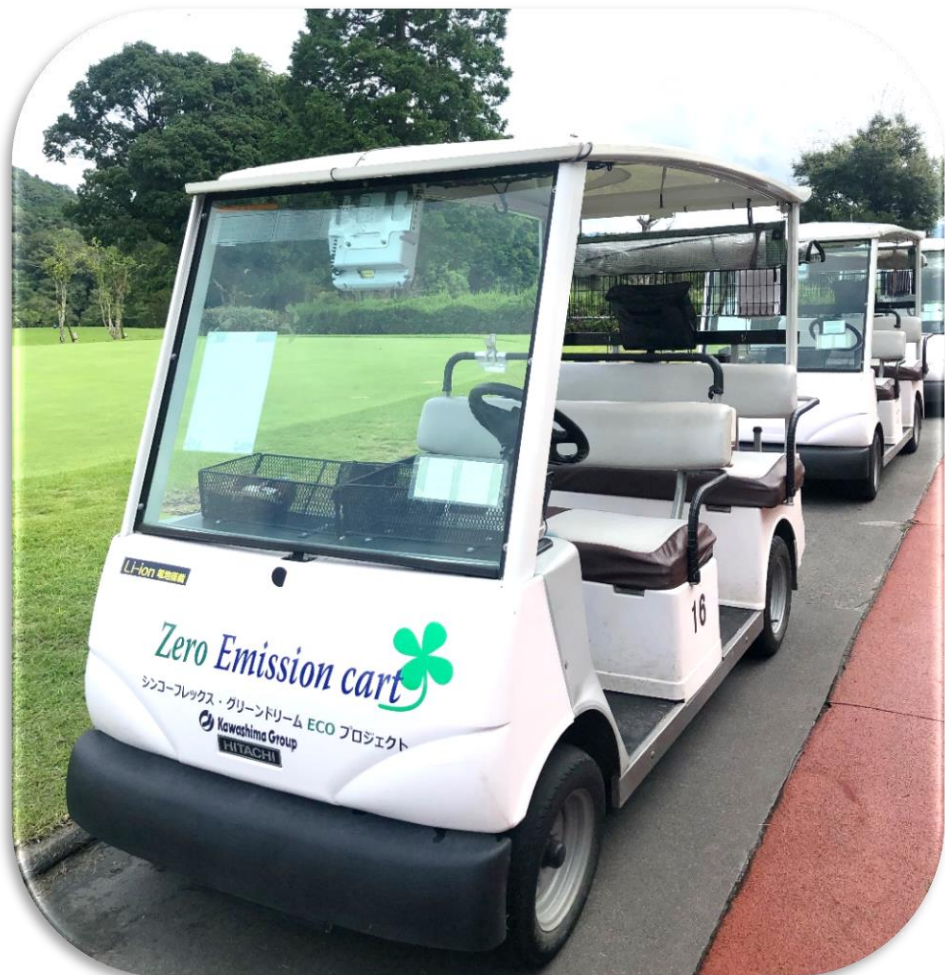
日本初のリユースリチウムイオンバッテリー搭載カート1号車
